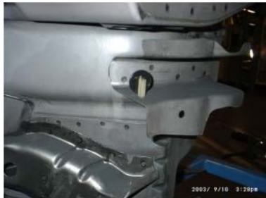
EDT in die Rohkarosse montiert
