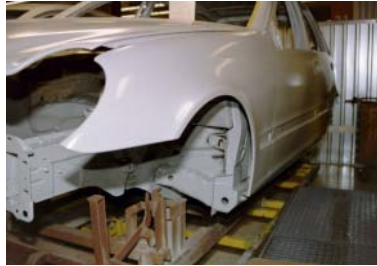
Fahrzeug nach dem KTL - Bad
